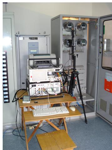
Figura 6 - Set de calibração em campo
