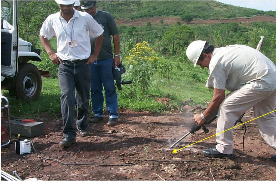
2- Na rocha exposta foi verificado sua resistência com um martelete eletro pneumático portátil a dureza da rocha
