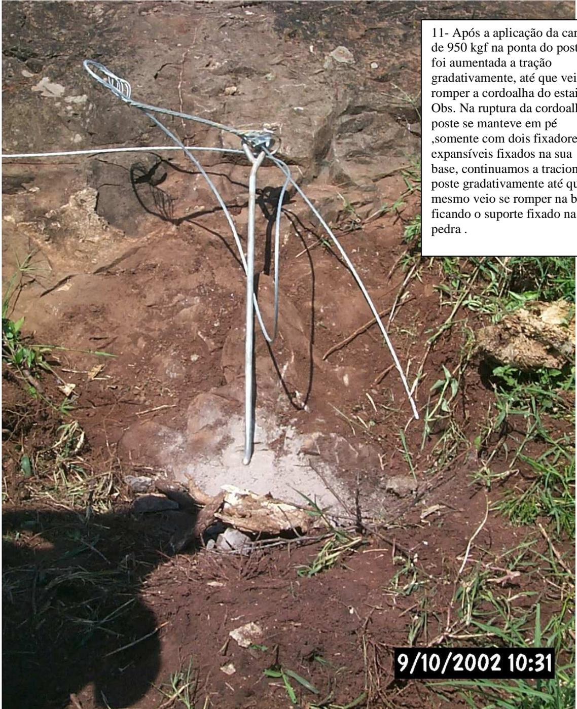
11- Após a aplicação da carga de 950 kgf na ponta do poste foi aumentada a tração gradativamente, até que veio a romper a cordoalha do estai .
