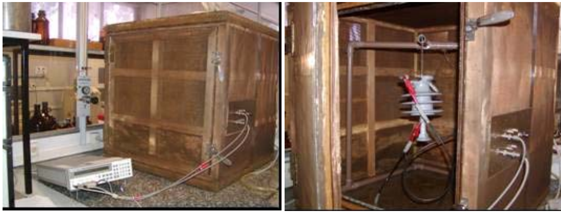
Figura 4. Arranjo experimental utilizado para as medidas de resistência de isolamento em isoladores.
