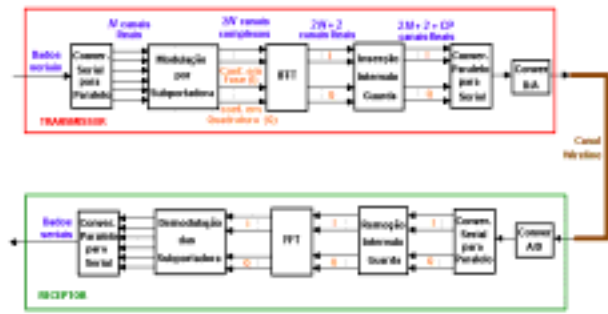
FIGURA 2. Modelo básico do modem OFDM.
