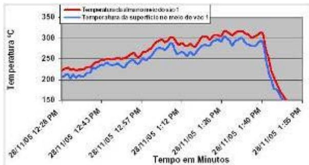
Figura 13: Ciclo de Alta Temperatura, diferença de temperatura entre a alma e a superfície do cabo foi de 15 a 20°C quando a temperatura aproximou dos 300°C.
