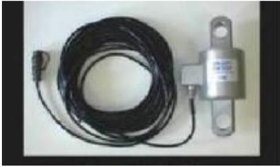
Figura 6: Célula de Carga do CAT 1
