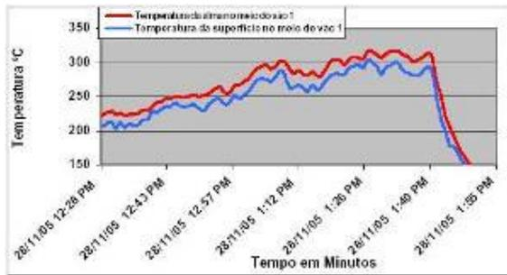
Figura 13: Ciclo de Alta Temperatura, diferença de temperatura entre a alma e a superfície do cabo foi de 15 a 20°C quando a temperatura aproximou dos 300°C.
