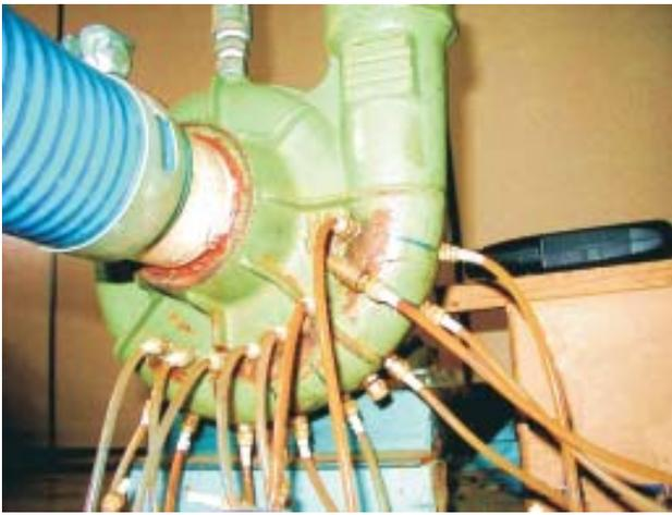
FIGURA 2 - Posicionamento das seções de medição de pressão diferencial na caixa espiral.
