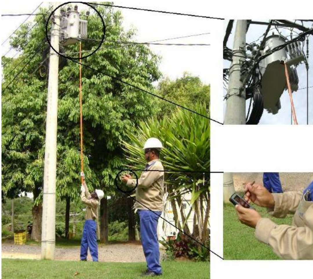
Figura 11: Teste em campo do leitor e do aplicativo no PDA
