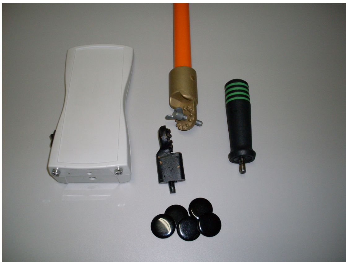
Figura 2. Protótipo leitor, etiquetas RFID e sistema de encaixe.
