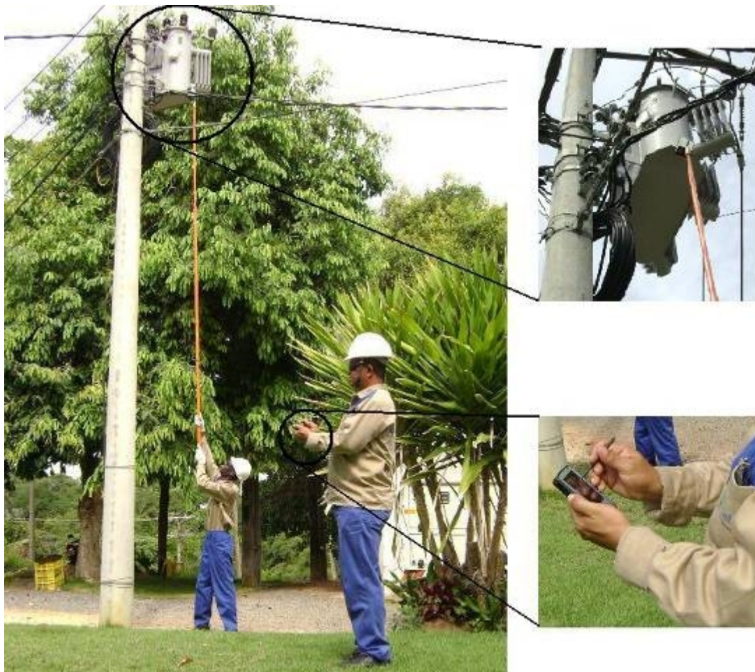
Figura 14. Teste em campo do leitor e da aplicação PDA .
