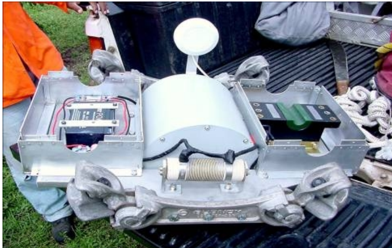
Figura 7. Vista interna do empacotamento mecânico dos sensores no meio do vão da LT
