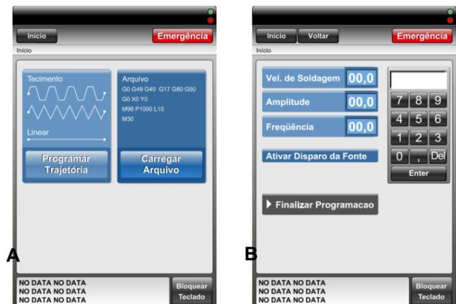
Figura 10. Telas de comando elaboradas para programação do manipulador robótico.
