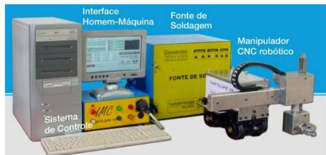
Figura 12. Componentes do sistema automático de soldagem.
