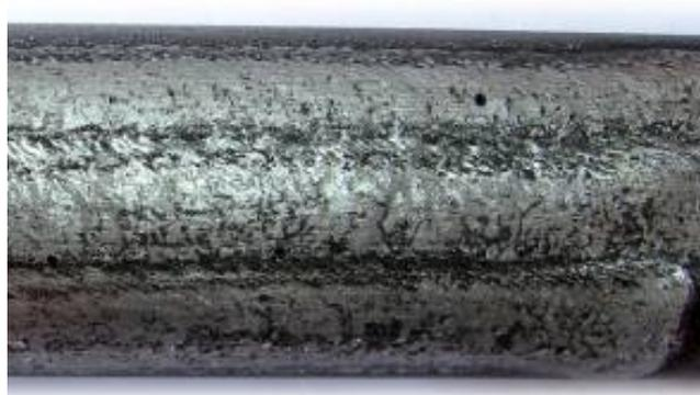
Figura 20. Tubo revestido com o processo PTAP.
