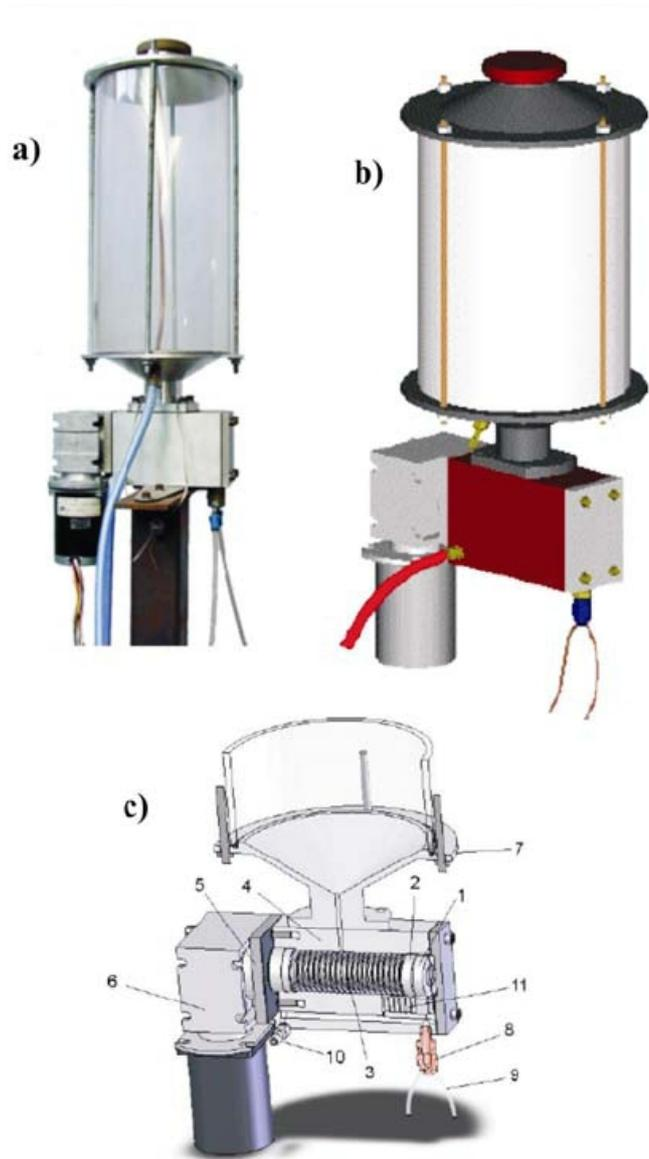
Figura 17. Modelo do Alimentador de Pó, a) foto, b) gerado em ambiente CAD, c) corte em ambiente CAD: 1-Vedação, 2-Rolamento, 3-Fuso transportador, 4-Corpo, 5-Tampa, 6-Motor, 7-Base reservatório, 8-Divisor, 9-Mangueiras flexíveis, 10-Entrada gás de arraste, 11-Distribuidor e ADP montado.
