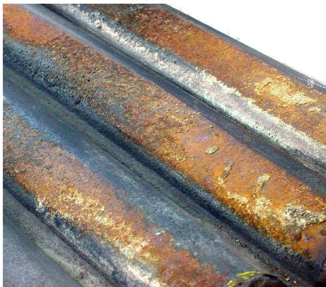
Figura 1. Região afetada por erosão e corrosão.
