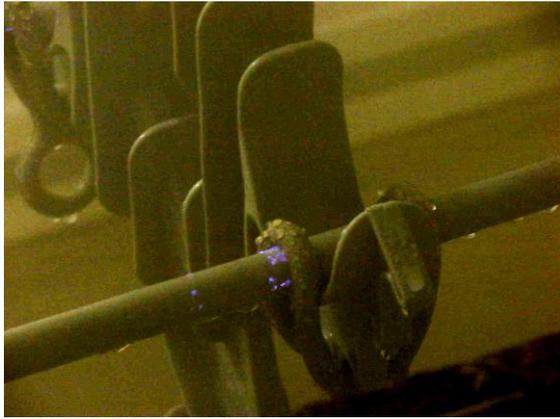
Figura 4 - Detalhe da descarga corona típica que ocorre na região entre o cabo e o anel de amarração
