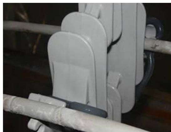
Figura 8 - Detalhe de trilhamento e erosão típicos ocorridos no cabo no ponto de amarração
