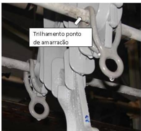
Figura 5 - Detalhe de trilhamento no ponto de amarração constatado no ensaio de longa duração
