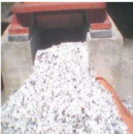
FIGURA 2 - Agregados de porcelana britados em britador tipo mandíbula.
