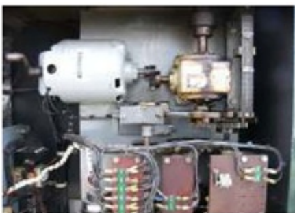
Figura 6 Accionamiento del Motor
