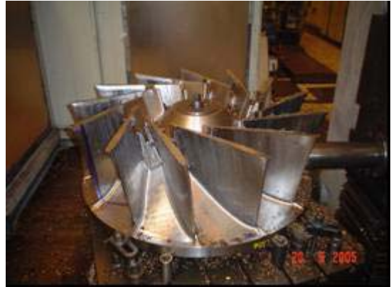
FIGURAS 5 e 6 – Fresamento utilizando o conceito “HPC-High Performance Cutter”.
