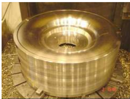
FIGURA 4 – Torneamento do disco da coroa
