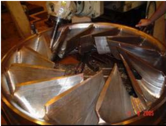
FIGURAS 5 e 6 – Fresamento utilizando o conceito “HPC-High Performance Cutter”.
