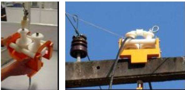
FIG. 1 – CARRETLHAS DE MÉDIA TENSÃO DESENVOLVIDAS
