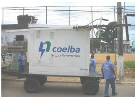
**FIG. 17 – UNIDADE MÓVEL COM TRANSFORMADOR AUXILIAR**
