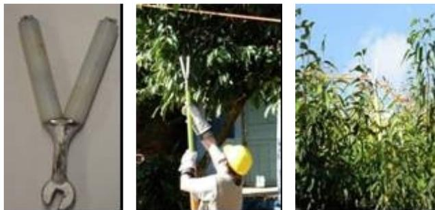
FIG. 7 – DISPOSITIVO AUXILIAR EM “V”
