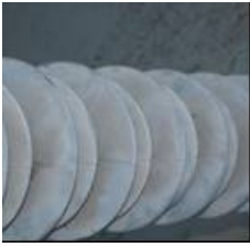
Figura 1 – Gizamento na superfície da saia do isolador
