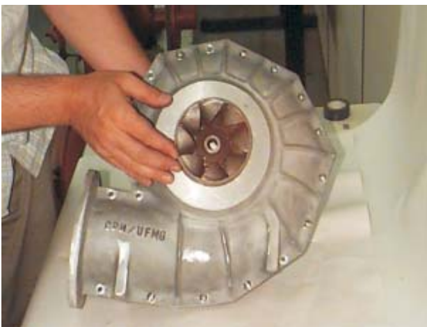
FIGURA 7 - Rotor e caixa voluta construído.
