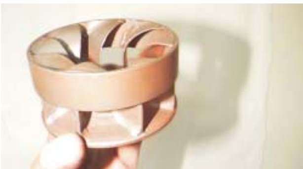
FIGURA 6 - Rotor Francis normal construído no CPH - UFMG.
