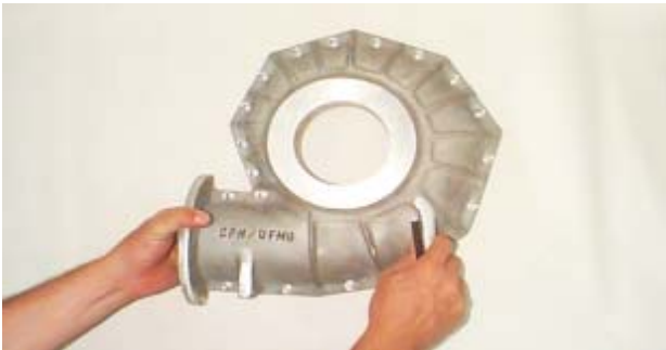
FIGURA 5 - Modelo fundido em alumínio.
