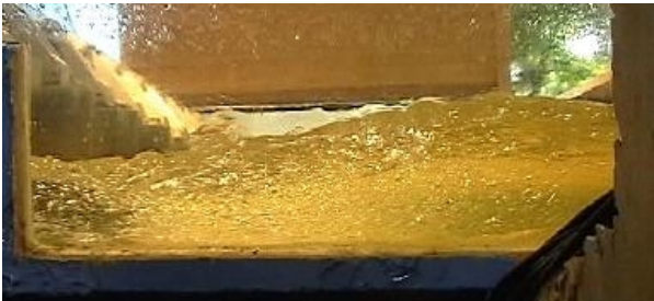
Figura 1 – Ressonho hidráulico no modelo reduzido (escala 1:100).
