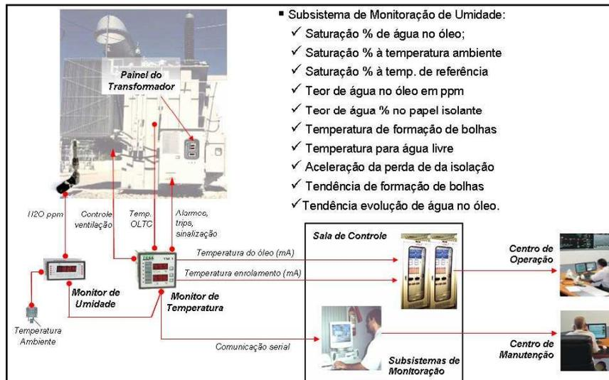
Figura 5 – Subsistema de Monitoração de Temperaturas e de Umidade
