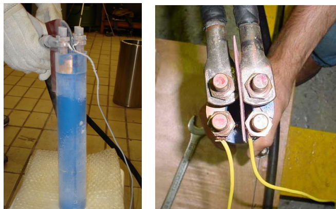
FIGURA 1 – Dispositivo Limitador de Corrente estudado (esquerda); conexões de cobre com os contatos
