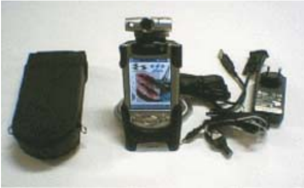
FIGURA 2 – Componentes do CDI: “Pocket PC” com o aplicativo de inspeção, câmera digital na jaqueta de expansão, base de comunicação, fonte de alimentação, cabos e a capa protetora.
