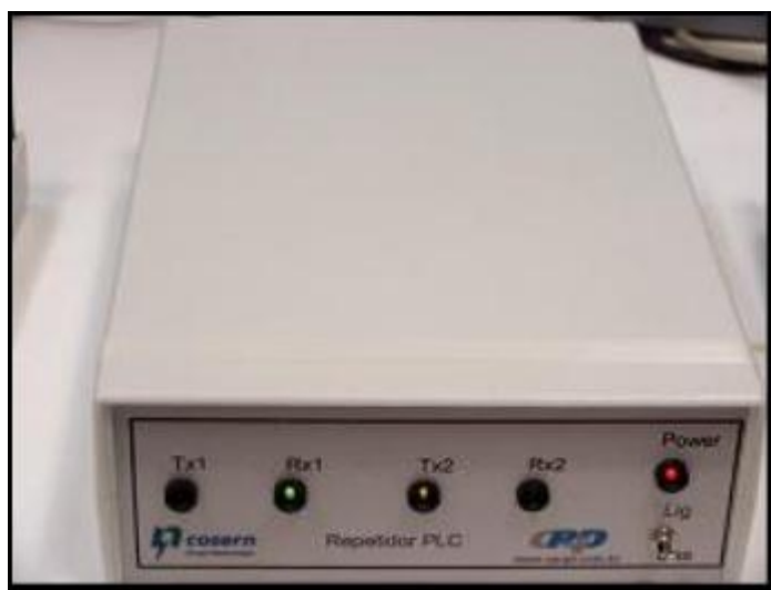
Figura 6. Repetidor PLC D. Acoplador PLC [3]
