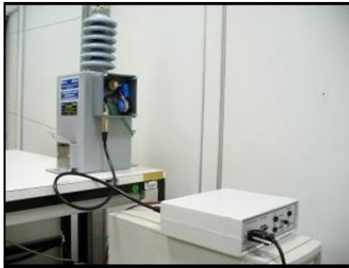
Figura 7. Acoplador PLC conectado ao Modem PLC (em laboratório)
