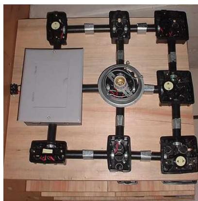
Figura 3 Painel de Treinamento em Execução de Instalação Elétrica
