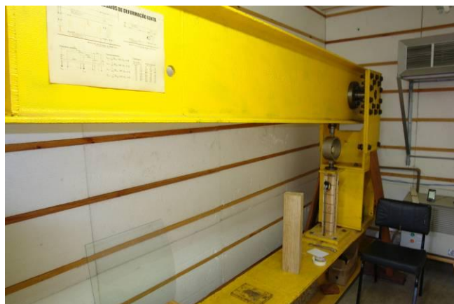
Figura 29 – Aparato utilizado no ensaio dos corpos de prova de fluência
