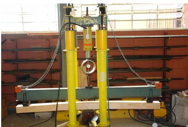
Figura 17 – Ensaio de flexão estática das cruzetas de MLC da madeira Pinus Oocarpa não tratada
