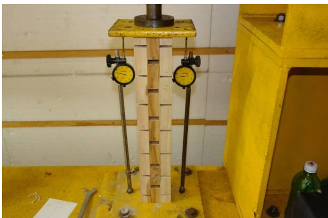
Figura 27 – Ensaio dos corpos de prova de fluência da madeira Teca não tratada
