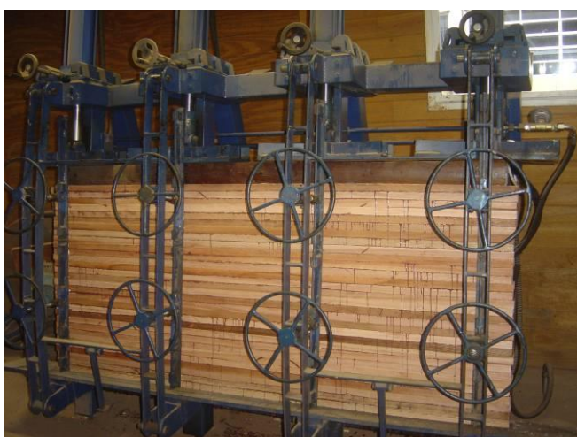
Figura 12 – Prensagem das cruzetas de MLC da madeira Lyptus® com adesivo RFF na prensa hidráulica tipo “A”
