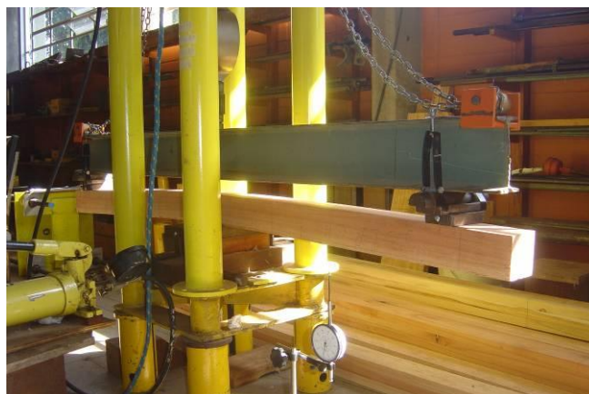
Figura 19 – Ensaio de flexão estática das cruzetas de MLC da madeira Lyptus® não tratada
