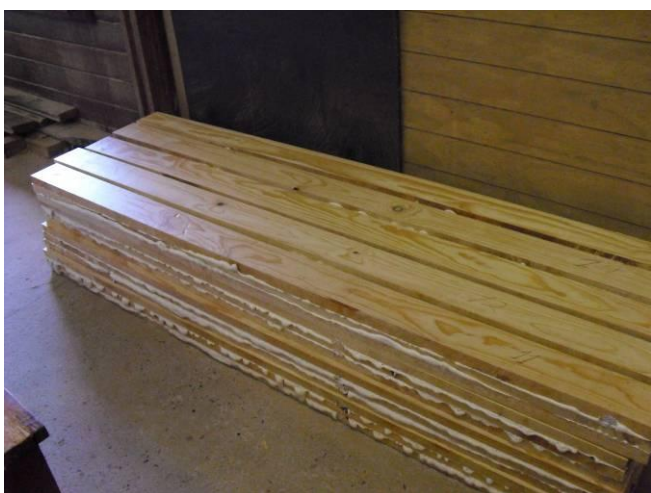
Figura 13 – Cruzetas de MLC da madeira Pinus Oocarpa com adesivo PUR após serem retiradas da prensa hidráulica tipo “A”
