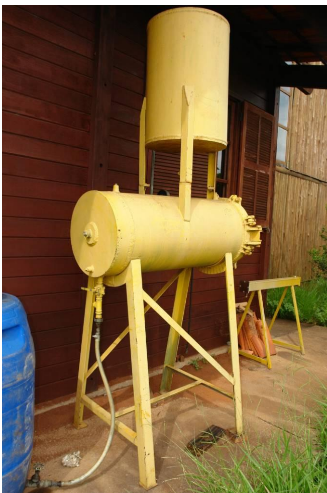
Figura 23 – Autoclave para ensaio dos corpos de prova de delaminação
