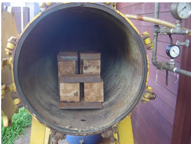
Figura 22 – Corpos de prova de delaminação da madeira Teca não tratada dentro da autoclave para ensaio cíclico
