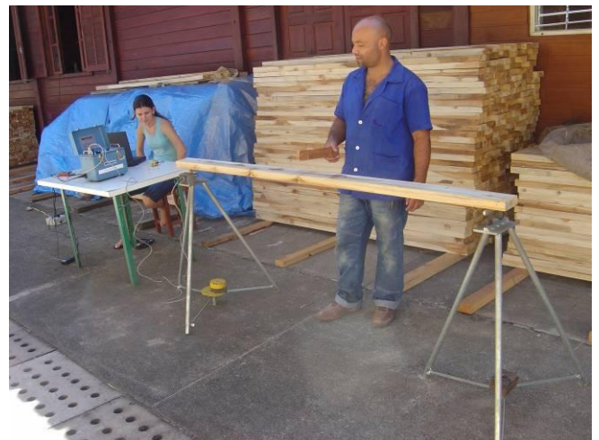
Figura 9 – Classificação mecânica das lâminas de madeira de Teca não tratada com aparelho
