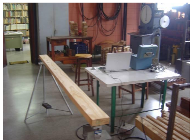
Figura 10 – Classificação mecânica das lâminas de madeira de Pinus Oocarpa não tratada com aparelho
