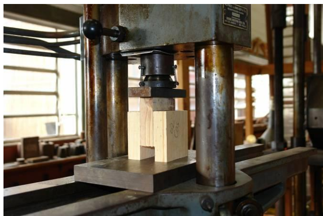
Figura 24 – Corpo de prova de cisalhamento da madeira Pinus Oocarpa não tratada
