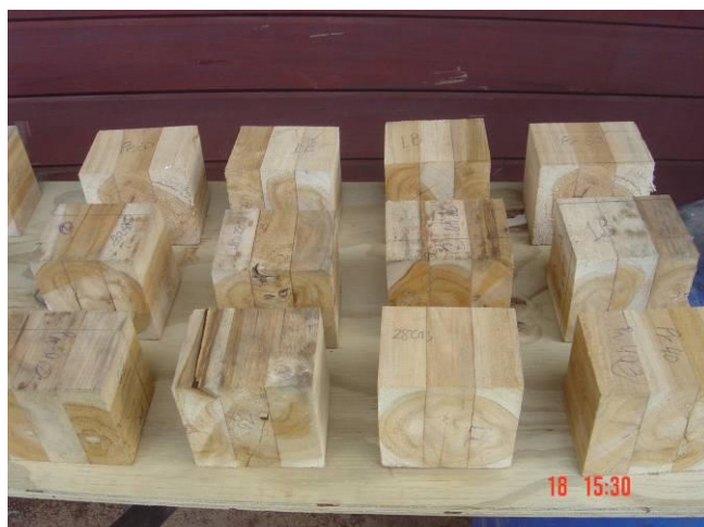
Figura 21 – Corpos de prova de delaminação da madeira Teca não tratada produzidas com adesivos RFF e PUR
