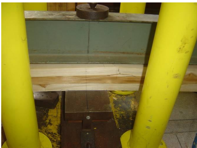
Figura 16 – Ruptura das cruzetas de MLC da madeira Teca não tratada no ensaio de flexão estática
