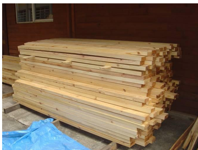
Figura 4 – Estocagem da madeira de Pinus Oocarpa não tratada para passar pelo processo de classificação visual
