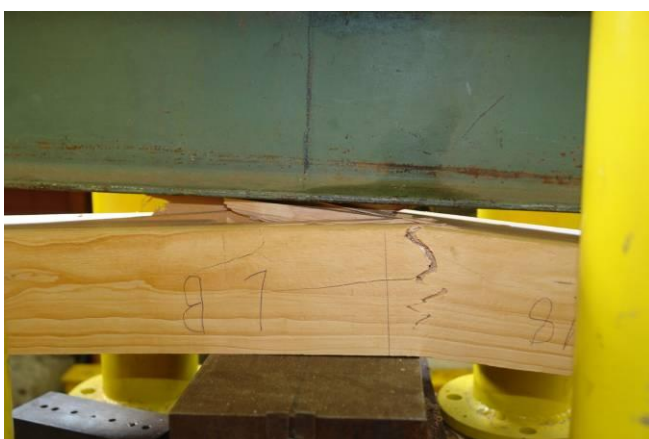
Figura 18 – Ruptura das cruzetas de MLC da madeira Pinus Oocarpa não tratada no ensaio de flexão estática
