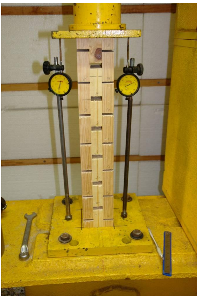
Figura 28 – Ensaio dos corpos de prova de fluência da madeira Pinus Oocarpa não tratada
