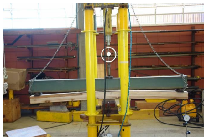
Figura 15 – Ensaio de flexão estática das cruzetas de MLC da madeira Teca não tratada
