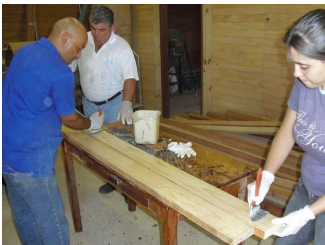
Figura 11 – Passagem de adesivo PUR nas lamelas de madeira de Pinus Oocarpa não tratada
