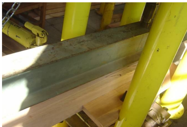
Figura 20 – Ruptura das cruzetas de MLC da madeira Lyptus® não tratada no ensaio de flexão estática
