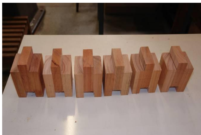
Figura 25 – Corpos de prova de cisalhamento da madeira Lyptus® não tratada
