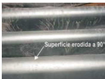
FIGURA 2 - Tubos de trocador de calor de uma usina termoeletrica. O aspecto brilhante da superfície superior sugere a maior erosão em ângulos de ataque próximos a 90°.
