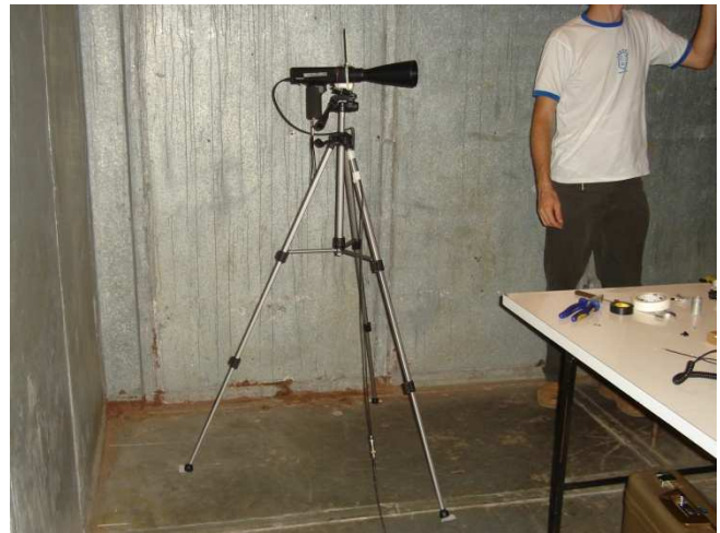
Figura 12 – Sensor de ultra-som posicionado para aquisição dos sinais.
