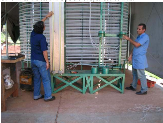
Foto 6. Estrutura suporte dos tubos das células de recalque.
