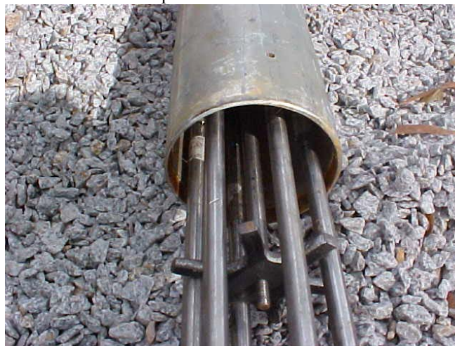
Foto 4. Dispositivo guia para a montagem das hastes.
