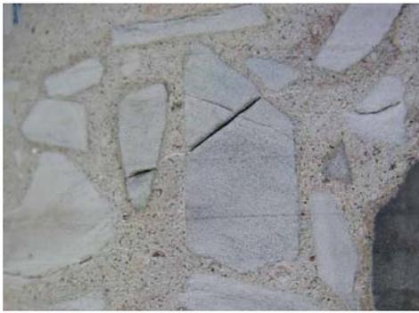
Figura 5. Fissuras nos agregados (C2)
