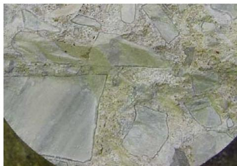
Figura 4. Bordas escuras e torno dos agregados (C2).
