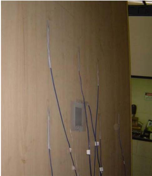
Figura 5 - Termopares e fluxímetro em amostra de madeira
