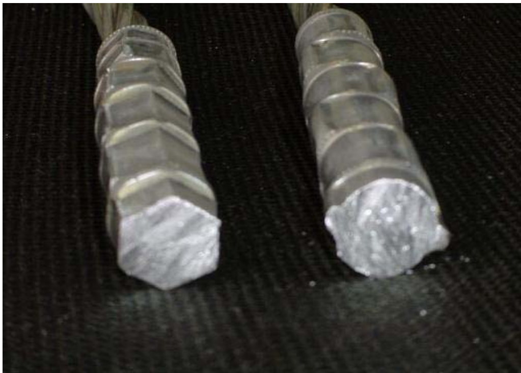
Figura XI – Conexão com uso de matrizes sextavadas e ovais
