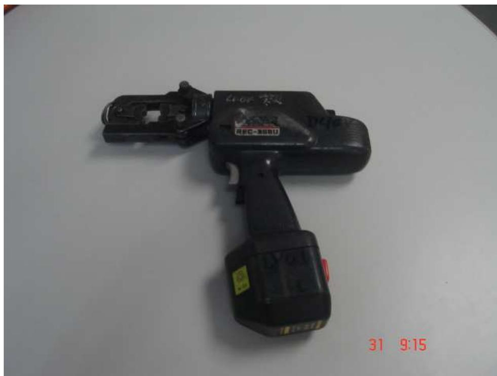
**Figura 2 – Foto do Alicete Eletro-Hidráulico**
